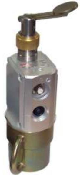
Для записи эхограммы датчик устанавливается на измерительный патрубок устьевого арматуры скважины и не требует использования соединительных кабелей. Выпускной клапан может вращаться без ограничения вокруг продольной оси для установки выкидного сопла в сторону от оператора.
